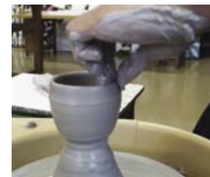
② 成形（ロクロ） 土をターンテーブルの中心に入れ、回しながら挽きあげます
