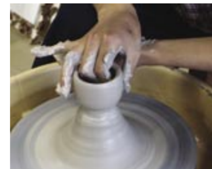
② 成形（ロクロ） 土をターンテーブルの中心に入れ、回しながら挽きあげます
