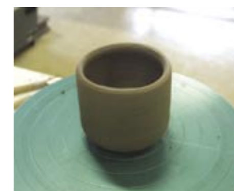
④ カンナを使い、裏側を削り高台をつくり、湯呑みが完成です
