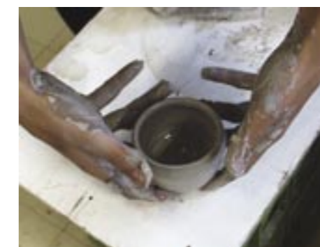
③ ロクロから切り離し、触ってもゆがまない程度まで乾かします（生乾き）
