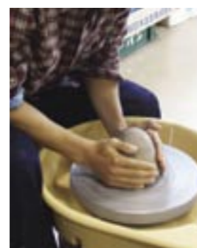
② 成形（ロクロ） 土をターンテーブルの中心に入れ、回しながら挽きあげます
